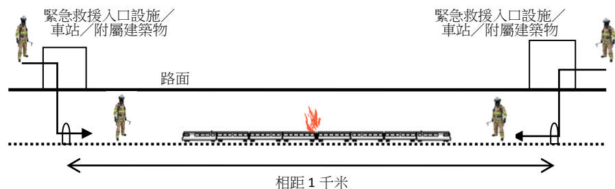
圖三：顯示地下及密封軌道內的緊急救援入口之間的最大距離為 1 千米的簡圖
