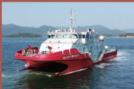
新消防船以雙體船式設計，並以鋁合金建造，排水量約407公噸。 The new aluminum catamaran displaces about 407 tonnes.
