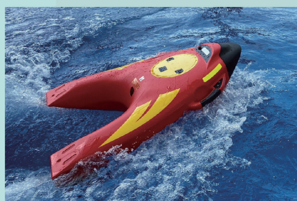
在沒有負重下，「遙控救生浮標」的最高速度可達每秒四米，能快速接近被救者。
