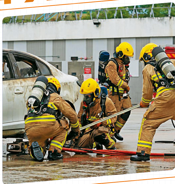
▲消防人員利用電池滅火系統針對車底的電池進行冷卻，防止因電池熱失控導致復燃。
