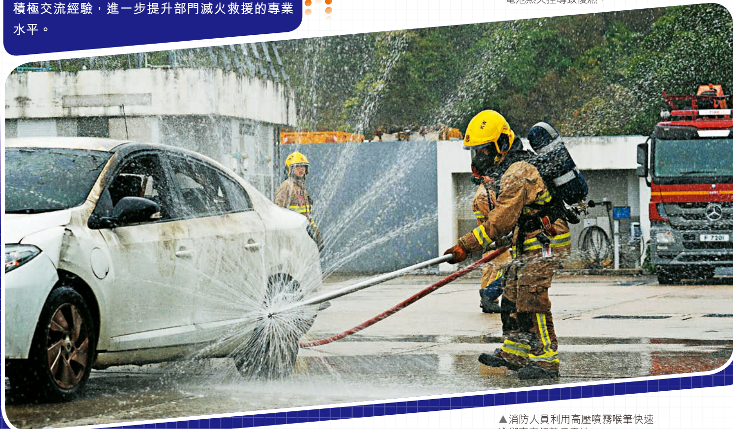
▲消防人員利用電池滅火系統針對車底的電池進行冷卻，防止因電池熱失控導致復燃。
