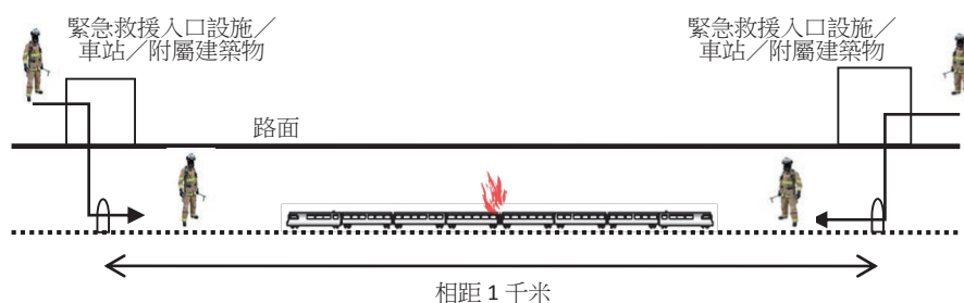
圖三：顯示地下及密封軌道內的緊急救援入口之間的最大距離為 1 千米的簡圖
