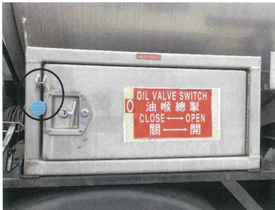
圖 2：於圖示位置加裝上鎖裝置以確保內藏快速關斷閥開關掣之控制箱能保持常關狀態並上鎖以符合危險品車輛有關之消防安全規定
