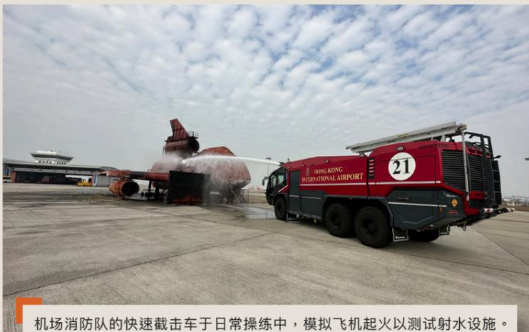
机场消防队的快速截击车于日常操练中，模拟飞机起火以测试射水设施。
