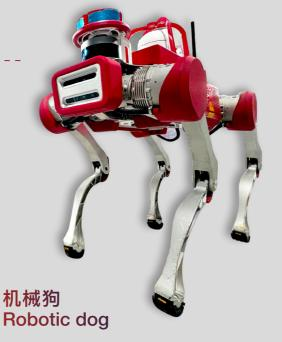
机械狗协助执行监测危害物质的行动,配备有毒气体探测仪、辐射探测仪、高清镜头和热能显像机,可代替消防人员迅速进入危害物质事故现场,侦测有毒气体及监测情况。
