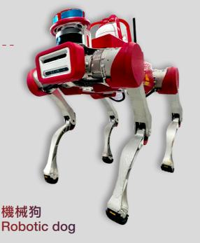
機械狗協助執行監測危害物質的行動,配備有毒氣體 探測儀、輻射探測儀、高清鏡頭和熱能顯像機,可代 替消防人員迅速進入危害物質事故現場,偵測有毒氣 體及監測情況。
