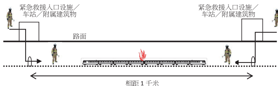
图三：显示地下及密封轨道内的紧急救援入口之间的最大距离为 1 千米的简图
