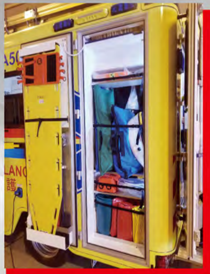
▲ 外置儲物櫃讓救護人員可於車外或車內取放物資，增加靈活性。
